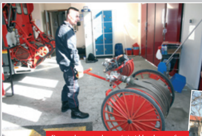
Denne slange-trækvogn (tv) sidder der to af bag på mange af BSPP's brandkøretøjer (som på foto 1h). Trækvognene kan frigøres og gør det nemmere at håndtere de tunge fødeslanger, mener de i Paris. De medgiver dog, at vognene ikke vil være til at trække rundt med i mere landlige omgivelser.
