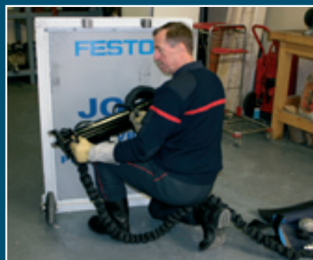
JOG trækkes ud manuelt, så den passer ind i dørkarmen. På selve apparatet aktiveres så den vandrette cylinder, der sætter JOG i spænd og trykker ud på karmen.
