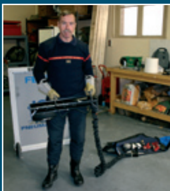
JOG er fremstillet i titanium for at holde vægten nede uden at miste robustheden i apparatet.
